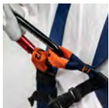
Ancre sternal composé de 2 boucles à sangles
