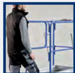
L'accès à la plate- forme se fait en poussant le portillon anti-chute
