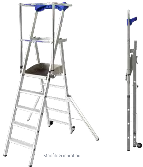
Verrous arrière anti-soulèvement | Larges pieds fixes également sur le modèle 6 marches | Système de verrouillage du garde-corps | Large porte-outils rigide compartimenté et ergonomique de série | Béquille pour passage d'obstacles pour les modèles 3 et 4 marches (WC) | Garde-corps 3 côtés avec sangles anti-chute et mise en place automatique | Stabilisateurs indépendants repliables dès le modèle 5 marches | Marches striées antidérapantes de 80 mm
