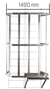
CHANGEMENT DE VOLÉE Échelle non fournie avec le changement de volée. Hauteur 2 m pour installation supérieure à 8 m. Passage latéral entre 2 volées d'échelles. Palier antidérapant. Se pose à gauche ou à droite.
