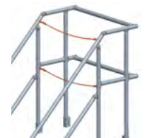
Câbles de sécurité
