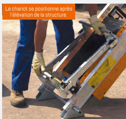
Eclisses d'échelles amovibles (mieux protégées pendant le transport).
