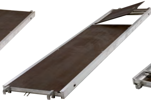
R08-CT 3000 x 730 à trappe Longueur : 3000 mm Largeur : 730 mm
