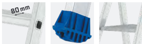
Marches striées 80 mm antidérapantes serties sur les montants
