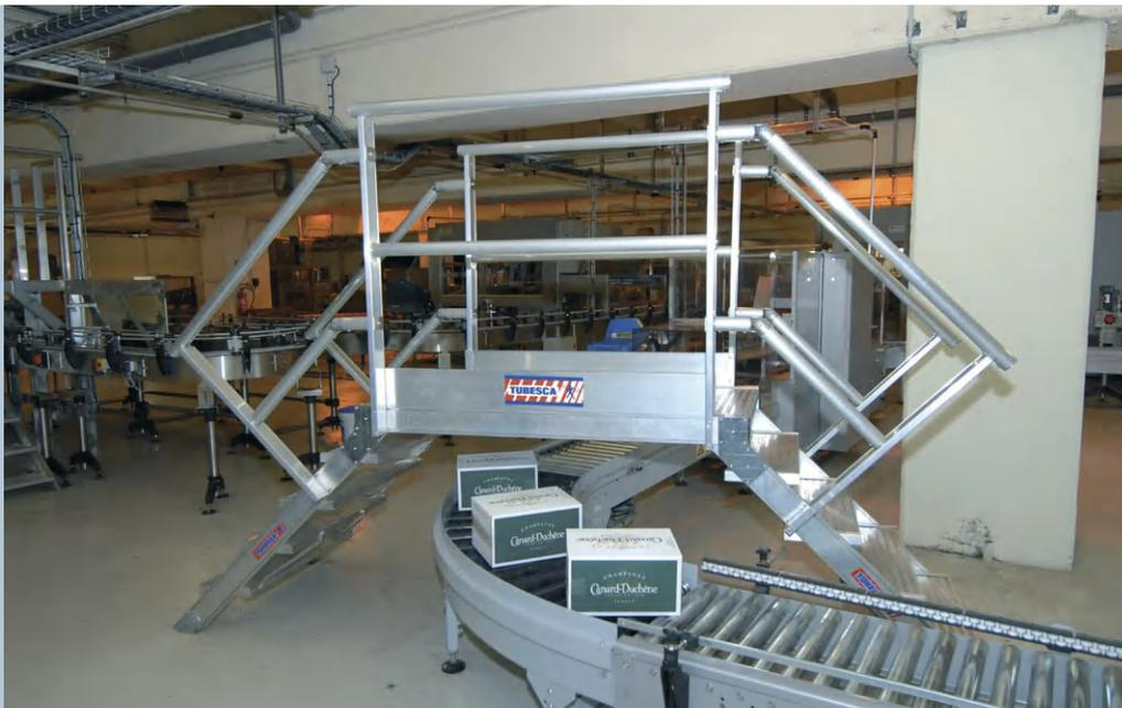
« Le concept « MODUL'ACCESS » reste l'unique solution que nous ayons trouvé pour faciliter le travail de nos techniciens. Ces passerelles, créées sur-mesure par Tubesca-Comabi, viennent parfaitement s'adapter à nos chaînes de conditionnement. En plus d'apporter toute la sécurité nécessaire à une maintenance sur des machines en fonctionnement, ces passerelles permettent une liberté de déplacement aisée, et par conséquent moins de fatigue. »
